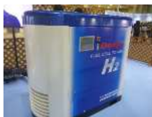
水素燃料電池式発電装置
